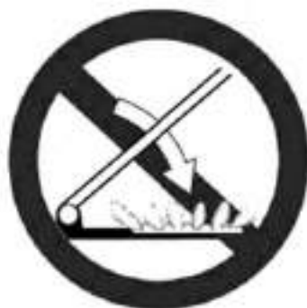
Рисунок F.1 — Предупреждающий знак «Не закрывать крышку при работающих горелках»
